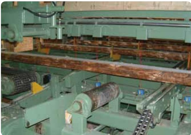
Obr. 2 Laserové triangulačné snímače merajú pozíciu a šírku kmeňu. Následne možno vykonať optimálny rez.
